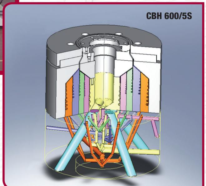
conducción cortísima del flujo se realiza en una sección circular para garantizar la ausencia de riesgos de paro o de zonas de sobrecalentamiento de los materiales y mínimos tiempos de permanencia.
