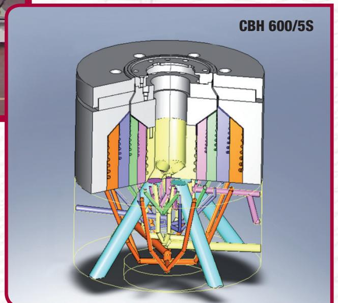
Конфигурация экструдеров и распределение по слоям определяется в зависимости от конечного применения пленок
